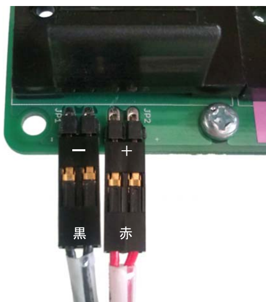
図 2.9: 電源ボードに電源ボード用電源ケーブルを取り付けた様子
