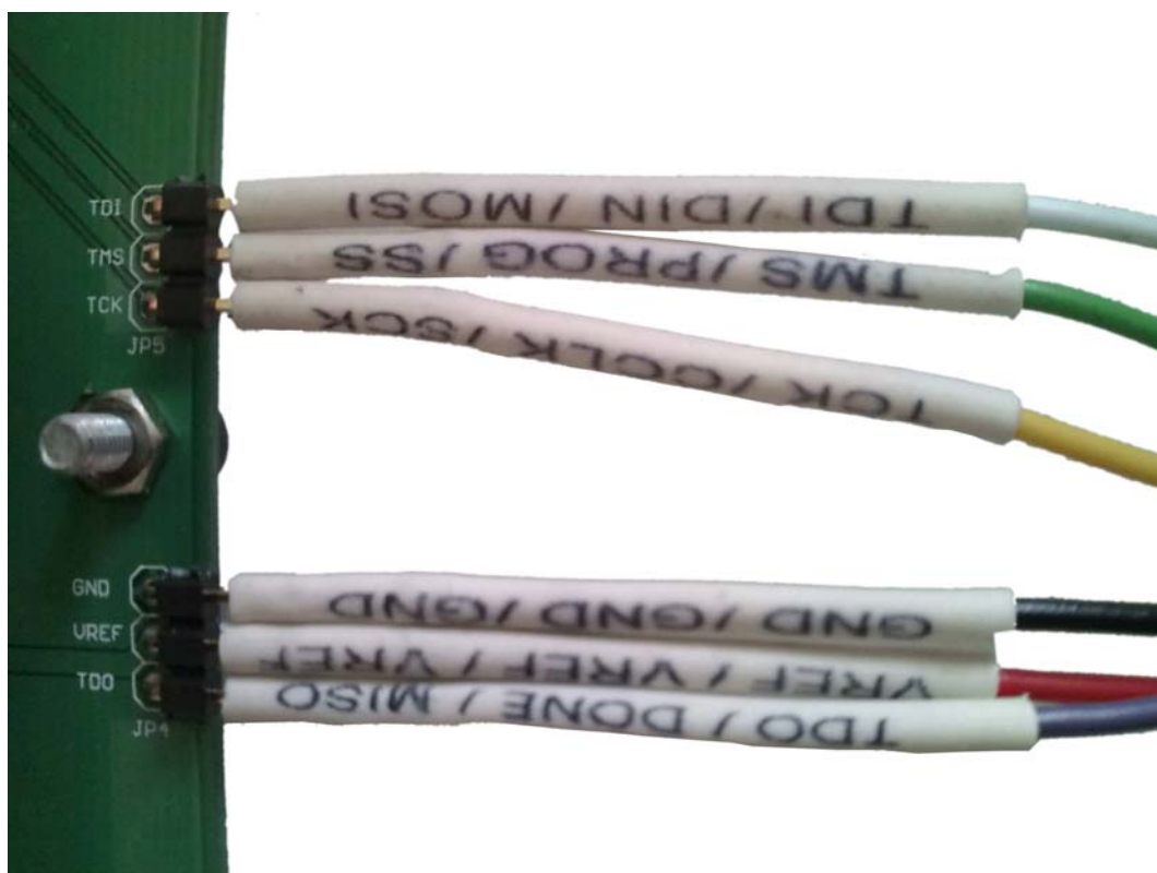
図 2.14: ベースボード用 JTAG 端子にダウンロードケーブルを接続した様子
