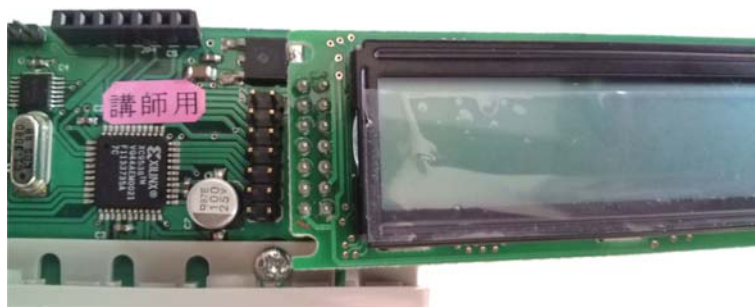
図 2.20: ドットマトリクスディスプレイボードに LCD を接続した様子
