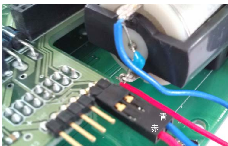
図 2.13: MCU 搭載ボードに右側モータを接続した様子
