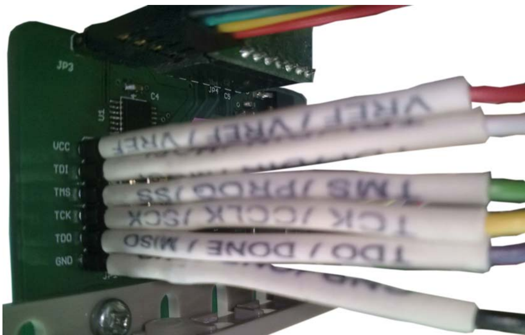
図 2.15: ドットマトリクスディスプレイボード用 JTAG 端子にダウンロードケーブルを接続した様子
